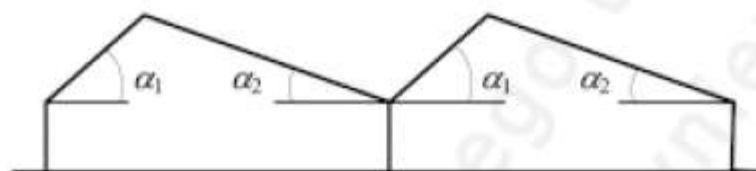
Rysunek 5.4: Współczynniki kształtu dachu dla dachów wielopołaciowych
